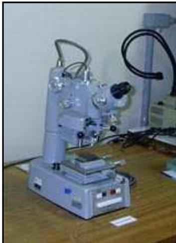
Figura 7 – Microdurômetro Vickers
